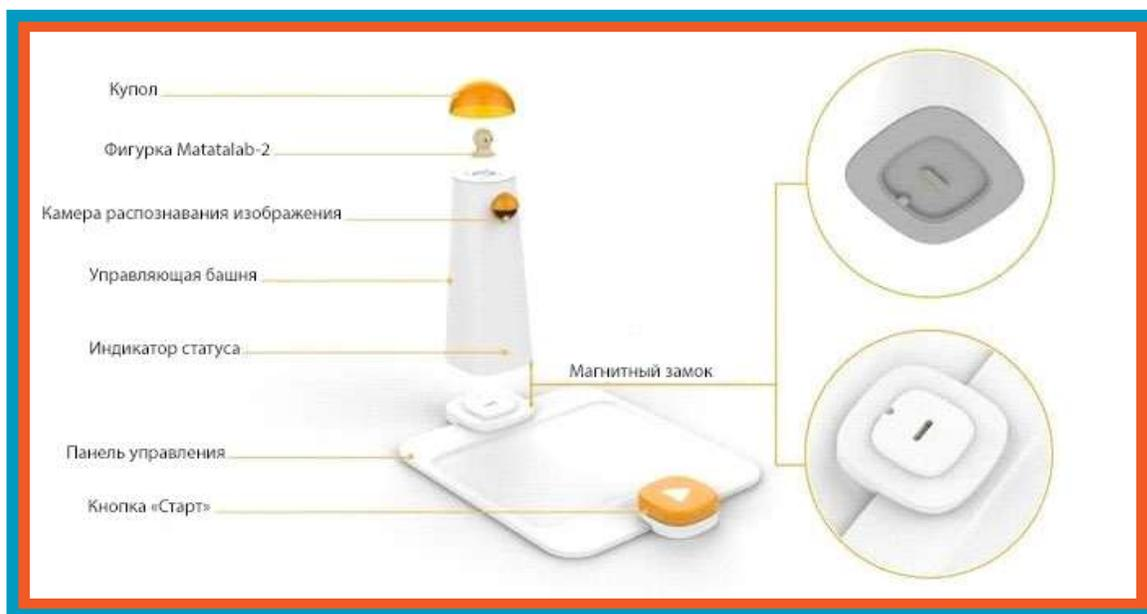
Когда программные блоки установлены на панели управления, следует нажать оранжевую кнопку «Старт», управляющая башня начнет считывать код с блоков при помощи камеры распознавания изображения (по рисункам на блоках) и отправит команду роботу по Bluetooth.
